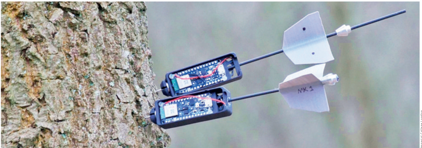
Die Flugroboter können mit Sensoren bestückte Pfeile selbst bei dichtem Waldbestand platzieren.
