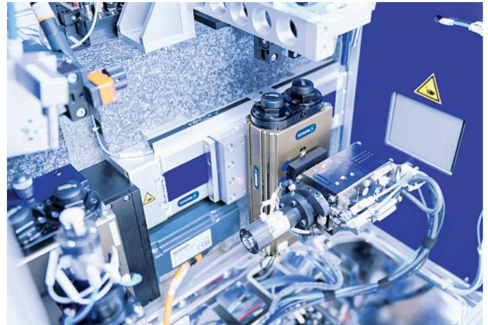
Kompakte elektrische Schunk ERD-Drehmodule versetzen die Teile zur Reinigung in Rotation. In die Drehmodule ist eine Mediendurchführung integriert, über die die Greifer angesteuert werden.
