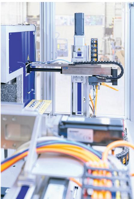
Mithilfe der kompakten Schunk ELS Auslegerachse werden die Teile aus der Reinigungskabine entnommen und dem folgenden Präge- und Prüfprozess zugeführt. Die Bewegung in Z-Richtung übernimmt auch hier eine robuste Beta 60, die über eine leistungsstarke Delta 110 am Boden in Y-Richtung verfahren wird.
