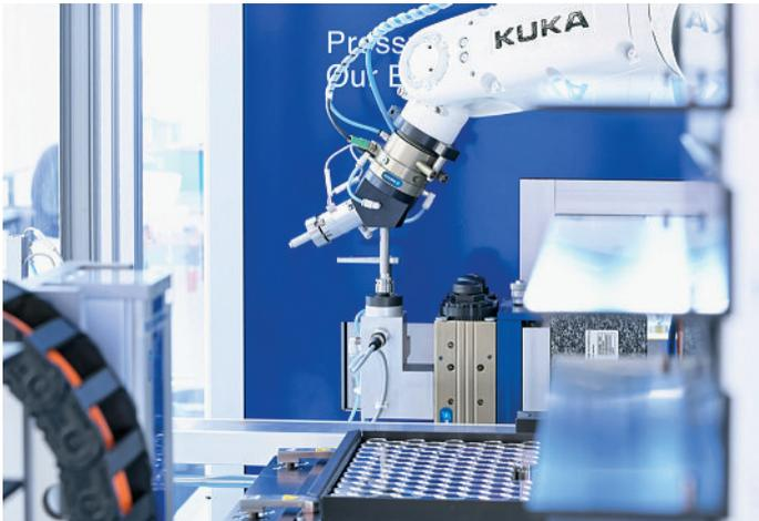
Mithilfe eines Roboters werden die Teile aus dem Pick & Place-Lager vereinzelt und einer Schweißnahtprüfung zugeführt. Über eine Schunk DDF-Drehdurchführung wird der Greifer mit Vakuum versorgt.
