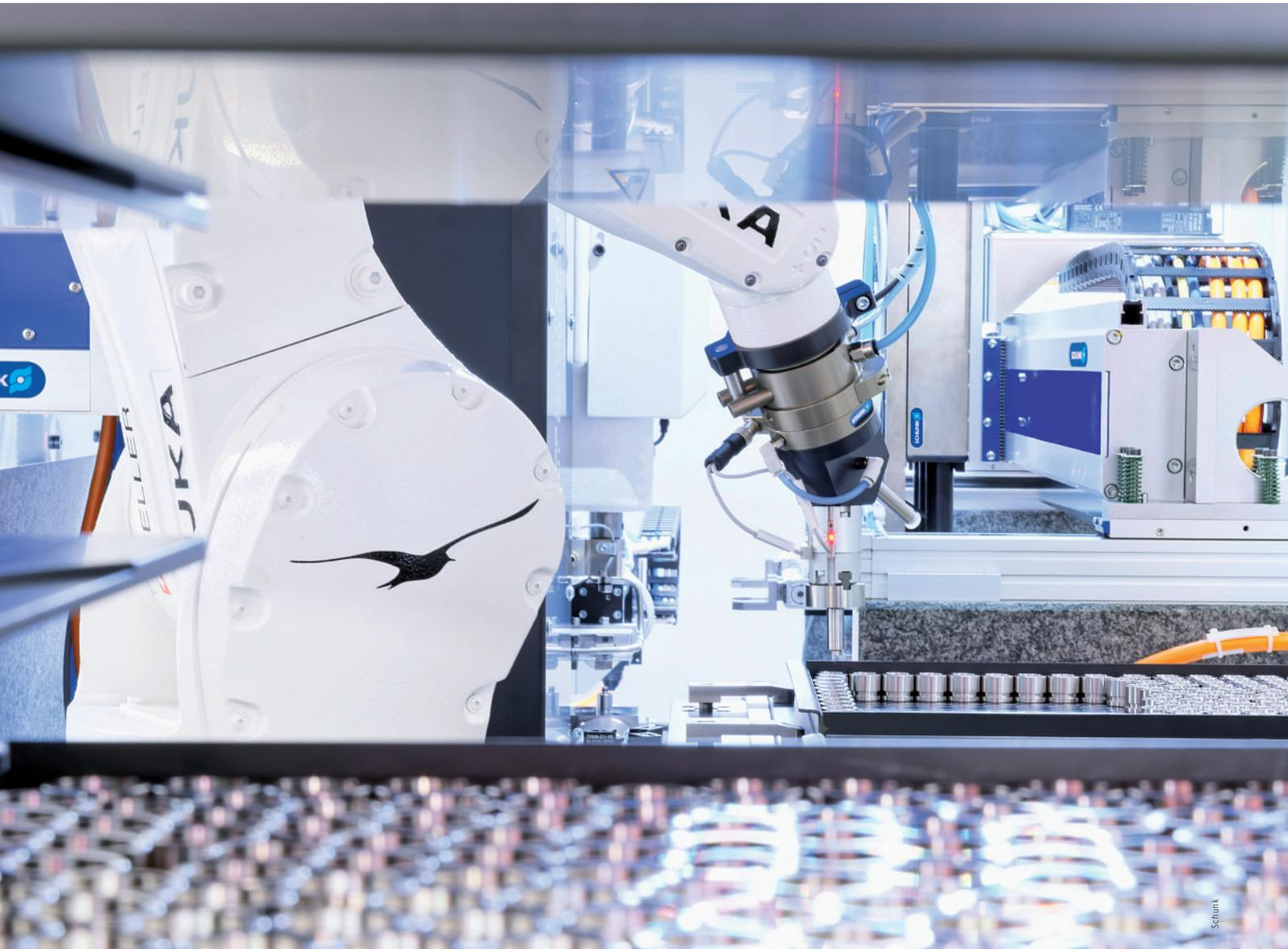
*In der Anlage werden künftig bis zu zwölf Bauteilvarianten vollautomatisiert produziert. Bei der Auswahl und Auslegung der Greifsystemkomponenten wurde die Keller AG umfassend von Schunk unterstützt. Hinter dem Roboter mit der Schunk-Mediendurchführung für den Vakuumgreifer ist ein Linearsystem zu sehen, das aus Schunk Beta, Delta und ELS Linearmodulen konstruiert wurde.*
