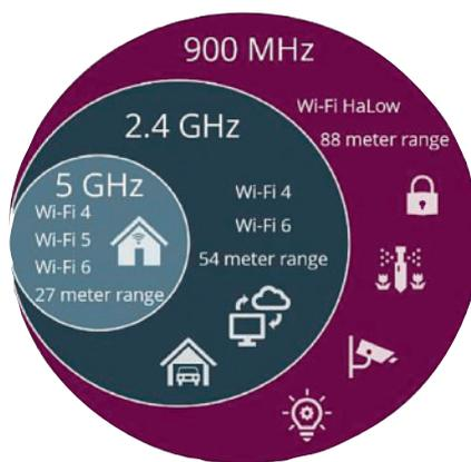
Bild 2: Beispiel einer Wi-Fi-Abdeckung bei 6 Mbps. Wi-Fi HaLow erweitert die Wi-Fi-Reichweite erheblich.
