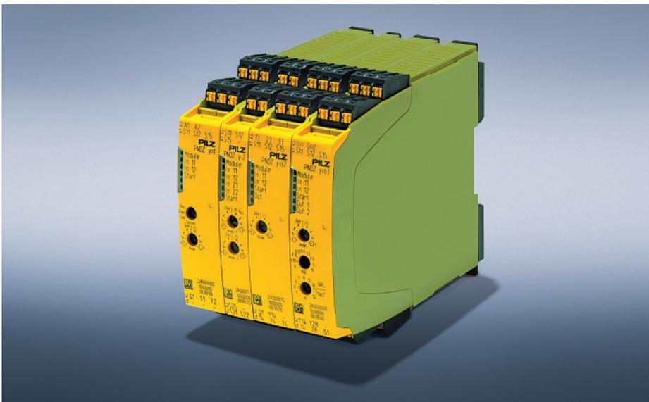
Die Module des Sicherheitsschaltgerätes myPNOZ werden auf einfache Weise über BUS-Stecker miteinander verbunden. Die logische Verknüpfung der Sicherheitsfunktionen wird über die Steckreihenfolge definiert.
