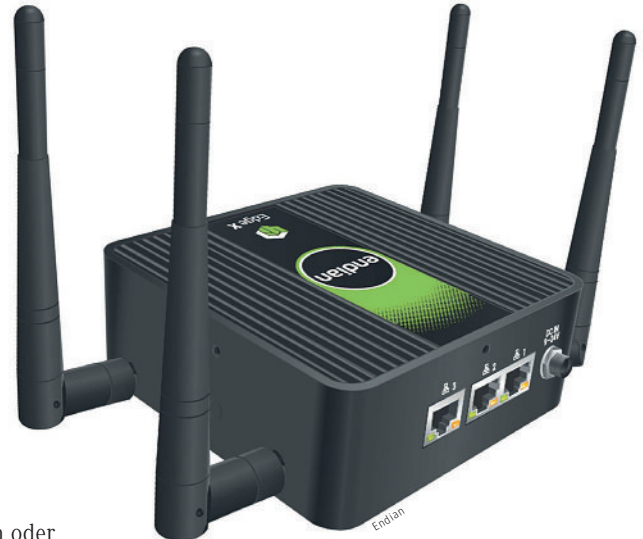
Das Endian 4i Edge X erfüllt alle Anforderungen an industrielle Sicherheit und Konnektivität mit einer breiten Palette an Konnektivitätsoptionen wie Ethernet oder 4G.
