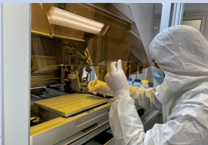
Im Reinraum des «Coating Competence Center» der Empa nutzen die Forscher hochspezialisierte Druckmaschinen, mit denen die leitfähige Tinte auf die Unterlage aufgebracht wird.
