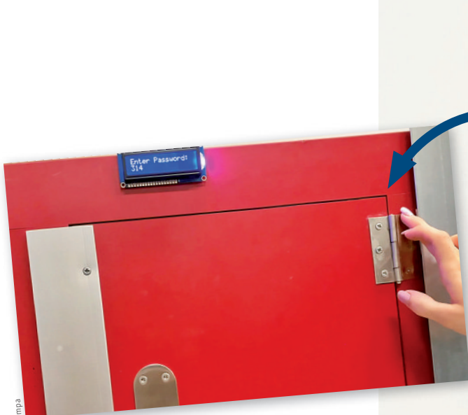
Prototyp: Nur Eingeweihte wissen, dass der Zugangscode auf der Folie am Türscharnier eingegeben werden muss.
