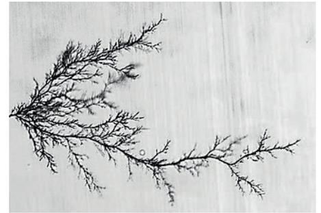
Bild 4: Dendriten-Bildung (verästelte Fortsätze) an einem Isolator entlang der Kriechstrecke.
